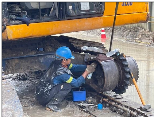
ภาพที่ 20 ใช้น้ำมันหล่อลื่นลดการเสียดสี
